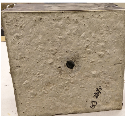
Bild på provkropp sätt ovanifrån med genomgående armering.
