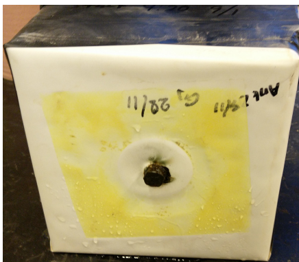
Bild på provkropp sätt underifrån med genomgående armering, efter vattentäthetsprovning.
