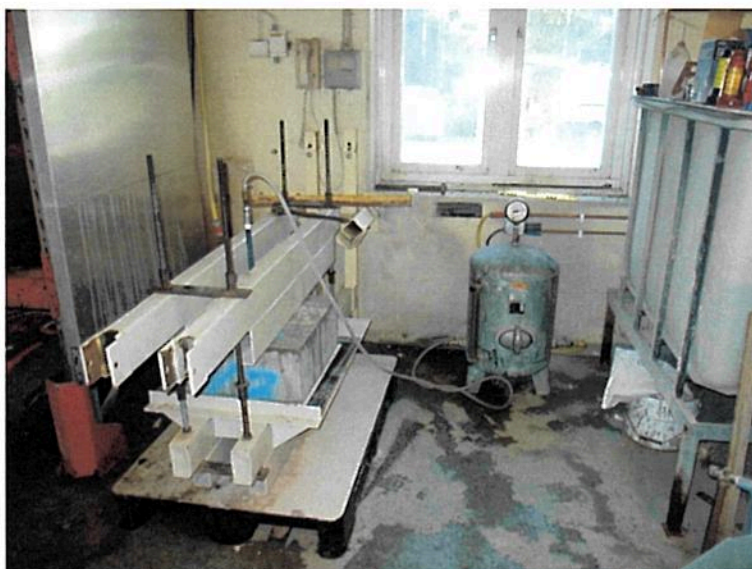
Foto 1. Provning av HyDra Membrane PMH-3080 (1,2 mm HDPE folie belagd med gel)
