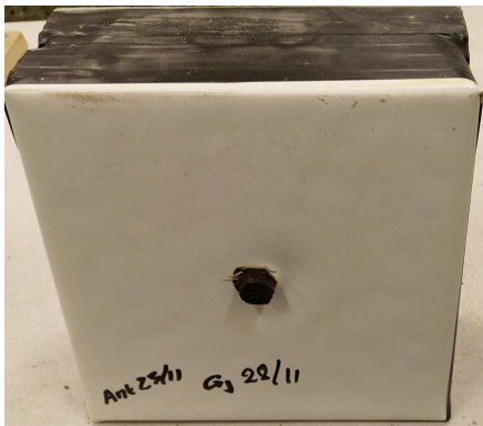
Bild på provkropp sätt underifrån med genomgående armering.
