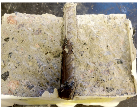
Bild på provkropp efter spräckning med genomgående armering, efter vattentätetsprovning. Ingen synlig fuktinträning. Tyvärr visas en mörkare yta skapad av skuggan från kameran.
