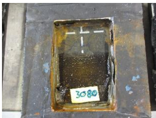
Hydra FB membrane 3080 / Hydra SAM Wall med Hydra Liquid Rubber Resultat 0,5 MPa (läckage i utrustning)
