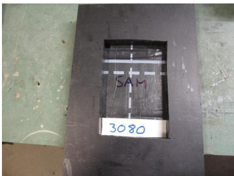
Bild på provkropp sett underifrån med skarv för test av vattentäthet.
