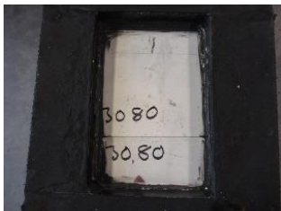
Hydra FB membrane 3080 / Hydra FB membrane 3080 Resultat 0,8 MPa (80 m vattenpelare)
