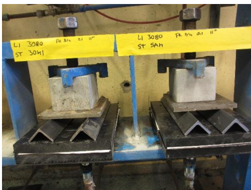
Bild på provkropp monterad för trycksättning i vattentäthetsrigg.
